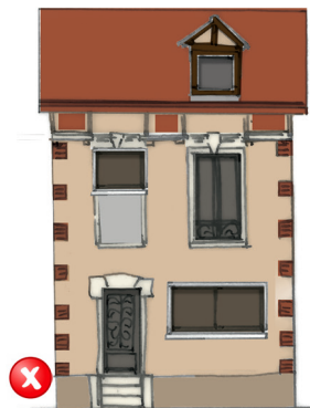
TRAVAUX INADAPTÉS : Modification des proportions des baies sans prise en compte de l'insertion par rapport à l'existant.
