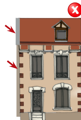
TRAVAUX INADAPTÉS : Réalisation d'une ITE partielle, sur un seul pignon, avec un bâtiment existant ne présentant pas de débord de toit. Dans ce cas la surépaisseur de l'ITE est visible et non intégrée à l'existant. Le prolongement en toiture est réalisé par une bande de zinc naturel.
